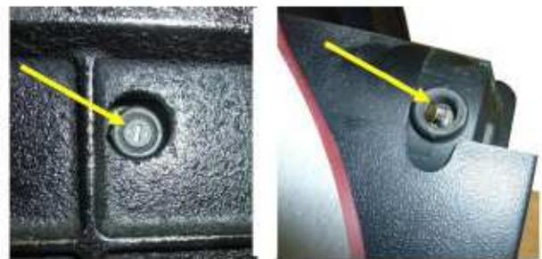
Imagen 11: Cambio de las escobillas de carbón
