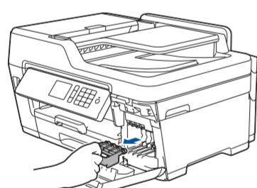
Abra la cubierta de los cartuchos de tinta y saque la pieza naranja de protección del equipo.
