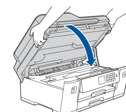
Baje la cubierta del escáner.
