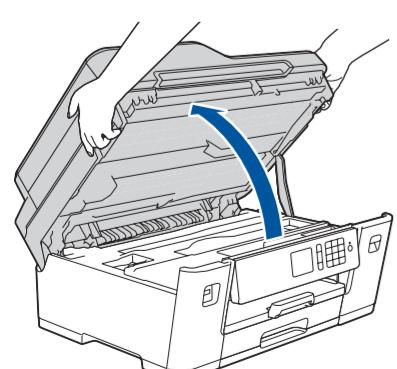
Levante la cubierta del escáner.
