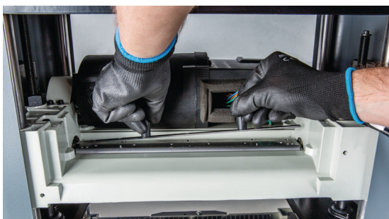
Fig. 24: cambio de cuchilla con la ayuda de imanes
