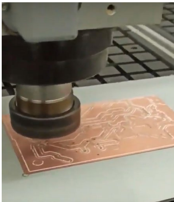
Ilustración 71. Fresado pistas de cobre en PCB
