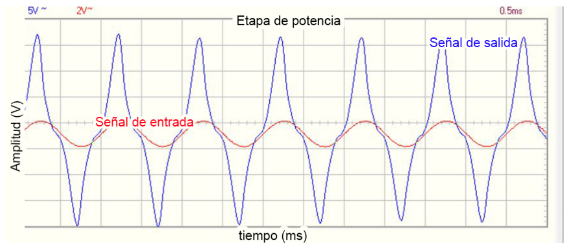
Ilustración 96. Señales de entrada y salida en la etapa de potencia
